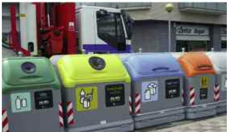
Los contenedores del sistema easy, al tener un único punto de enganche en la parte superior, permite dos amplias puertas en los laterales, facilitando la introducción de residuos. Además, por su diseño, permiten mayor volumen de almacenaje en un menor espacio. Por ejemplo, un contenedor "easy" de ocho metros cúbicos ocuparía sólo 3,3 metros.
