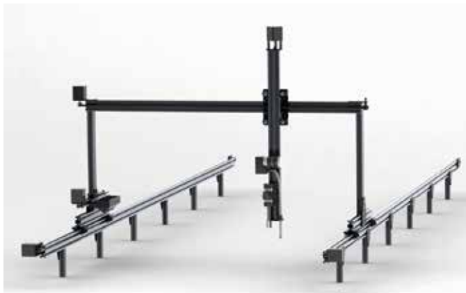
Estructura del Farmbot para que se vea sus similitudes con una impresora 3D.
