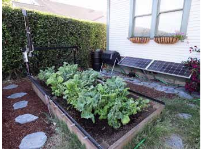
Fotografía global del Farmbot, en el que se ve el recolector de agua y placas solares.
