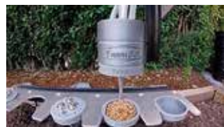
Estructura del Farmbot cogiendo las distintas herramientas para plantar semillas, regar, quitar las malas hiervas etc...
