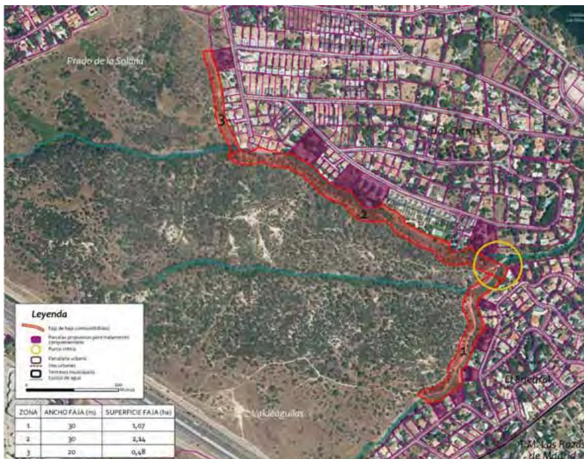
Fig.7. Diseño de las fajas perimetrales tramos 1, 2 y 3.
