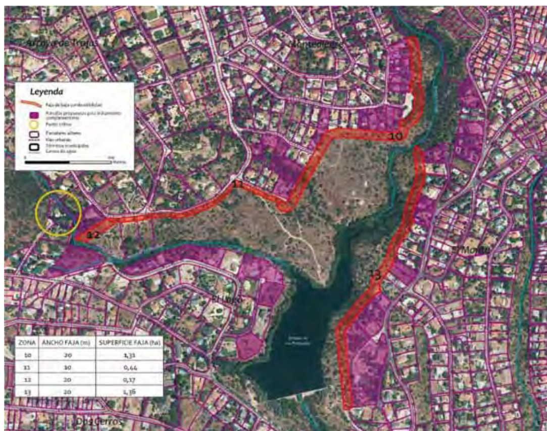
Fig. 11. Diseño de las fajas perimetrales tramos 10, 11, 12 y 13
