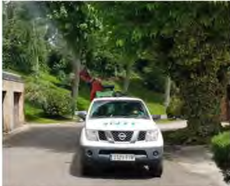
Vehículo de fumigación con cañón nebulizador
